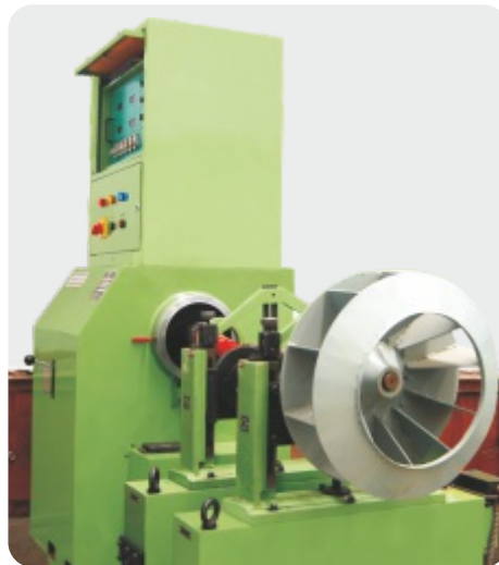
Fan Balancing M/c
